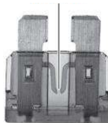
Fusible est grillé
